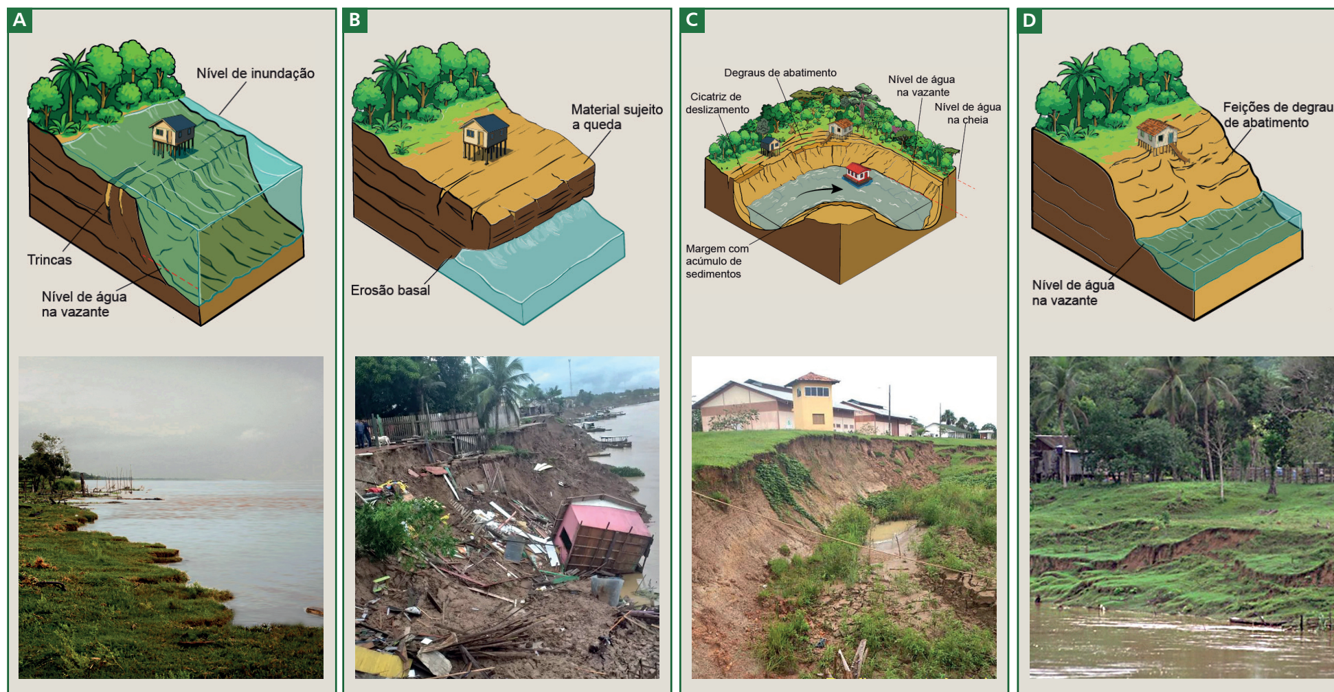
Figura 3.39: (A) Esquema ilustrativo exibindo o processo de terras caídas, no período de cheia dos rios amazônicos e, abaixo imagem da margem esquerda do Rio Amazonas, município de Óbidos, estado do Pará, com feições erosivas associadas à erosão marginal e movimento de massa (2023); (B) Esquema ilustrativo exibindo a erosão fluvial na base do talude marginal e evidências de rachaduras no topo, indicando alta suscetibilidade à queda de material e, abaixo imagem exibindo as terras caídas na margem esquerda Rio Purus, município Boca do Acre, estado do Acre (2021); (C) Esquema ilustrativo mostrando risco de moradia no topo do barranco e casa flutuante de serem atingidas por terras caídas e, abaixo imagem exibindo o deslizamento nas margens do Rio Juruá, município Cruzeiro do Sul, Acre (2015); (D) Esquema ilustrativo de casa com alta vulnerabilidade social em risco de ser atingida por terras caídas e, abaixo imagem de depósitos aluvionares do Rio Acre, submetidos a processos de rastejo, no município de Brasiléia, Acre (2015).
