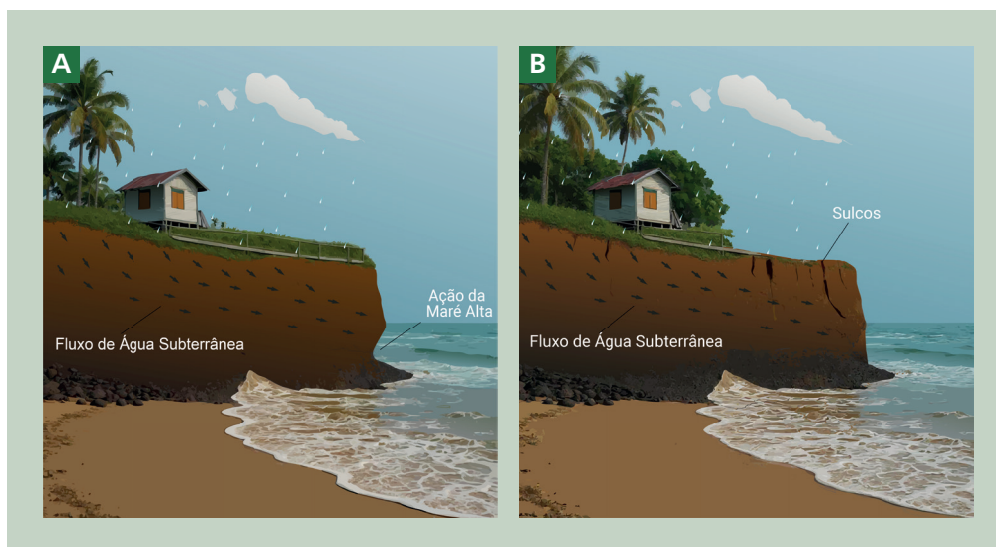
Figura 3.10: Esquema dos processos envolvidos no recuo das falésias: (A) Solapamento do topo em função da erosão da base da falésia pela ação da maré alta. (B) Ocorrência de deslizamentos no topo das falésias. Imagem gerada por inteligência artificial a partir de descrições de processos geológicos. Fonte: Elaborado por Almir Costa.
