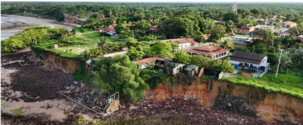
Figura 3.11: Falésia submetida a processo de erosão fluviomarinha na Praia do 40 do Mocoóca (município de Maracanã, estado do Pará). Observa-se a destruição de casas localizadas no topo da falésia em decorrência da erosão. Fonte: Foto da Defesa Civil do Município de Maracanã.
